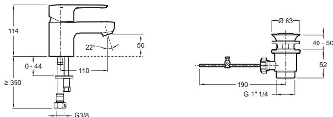
Description : Mitigeur lavabo avec flexibles d'alimentation PEX et bonde métal.. E16027-4D. Collection : JULY. Poids : 1,5 kg. Type d'installation : 1 trou. Normes et réglementations : NF : I - ECAU : E0 C2 A2 U3 (Ge3) - ACS : 10 ACCLY 113. Débit : 10 l/mn sous 3 bars. Mécanisme : Cartouche à disques céramique. Bonde de vidage en métal. Tirette latérale. Economiseur d'eau : butée sensitive. Flexibles d'alimentation PEX haute résistance.
