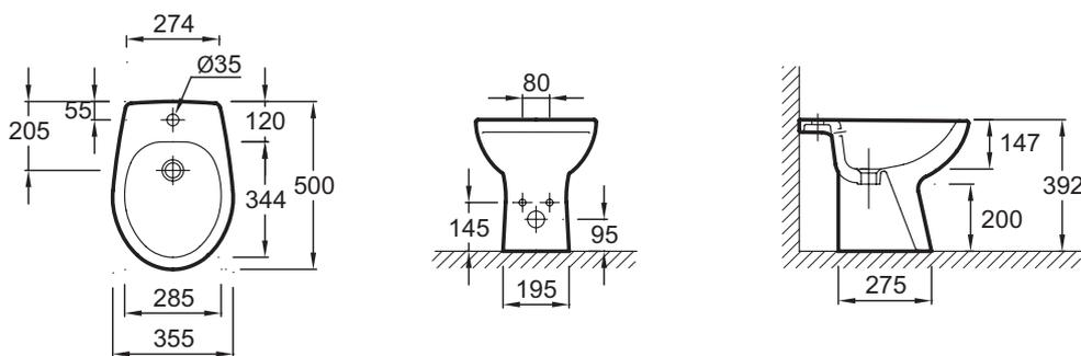
Descriptif CCTP : Bidet au sol. E4382. Collection : BRIVE. Dimensions : 50 x 35,50 cm. Poids : 13,5 kg. Matériau : Céramique. Type d'installation : Au sol. Hauteur : Standard. Percé 1 trou.
