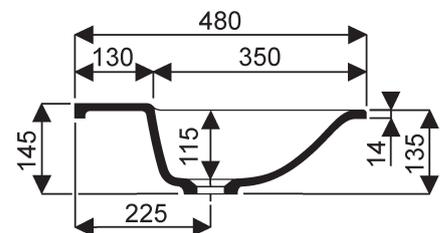
Vue en coupe des plans Xeno<sup>2</sup> de 160 et 140 avec ou sans trous de robinetteries.
