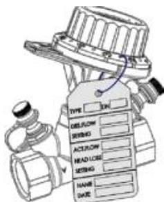
Le volant peut être verrouillé dans n'importe quelle position: introduire la plaque dans le trou sur le col du volant. La position du volant est préréglée.
