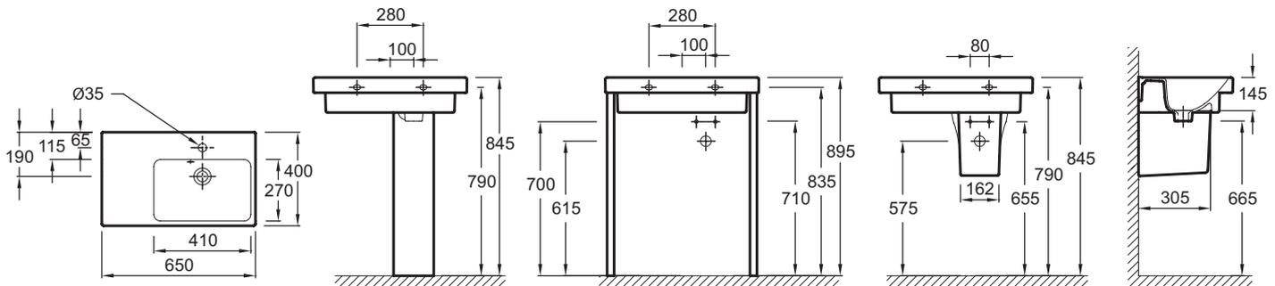
Descriptif CCTP : Plan-vasque 65 cm, vasque à droite. E4758G. Collection : ODÉON UP. Dimensions : 65 x 40 cm. Poids : 18,5 kg. Matériau : Céramique. Type d'installation : Autoportant ou peut être monté sur un meuble spécifique. Percement et pré-percement robinetterie : Percé 1 trou de robinetterie. ROBINETTERIE CONSEILLÉE : Aleo, une gamme design très accessible.
