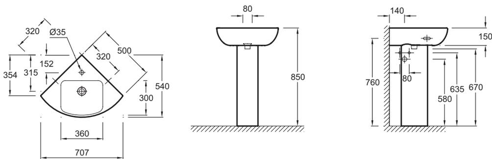
Descriptif CCTP : Lavabo d'angle 50 cm. E4710. Collection : ODÉON UP. DIMENSIONS : 50 x 50 cm. POIDS : 16 kg. MATÉRIAU : Céramique. TYPE D'INSTALLATION : Autoportant ou peut être monté sur un meuble spécifique. PERCEMENT ROBINETTERIE : Percé 1 trou pour robinetterie. CONFIGURATION : ANGLE. TROP-PLEIN : Avec trou de trop plein. PRODUIT INCLUS : (robinetterie non incluse). ROBINETTERIE CONSEILLÉE : Aleo, une gamme design très accessible.
