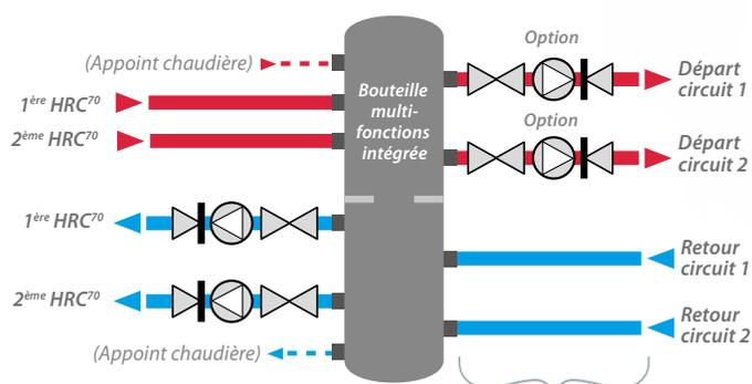
Jusqu'à 4 circuits chauffage et/ou sanitaire avec 2 HRC<sup>70</sup> 25 ou 2 HRC<sup>70</sup> 32 et 3 circuits de chauffage ou sanitaire avec 3 HRC<sup>70</sup> 32.
