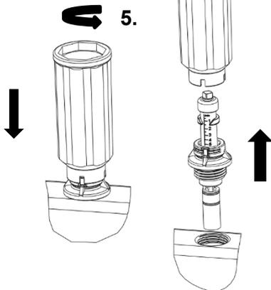
4. Positionner l'outil de démontage sur le débitmètre
