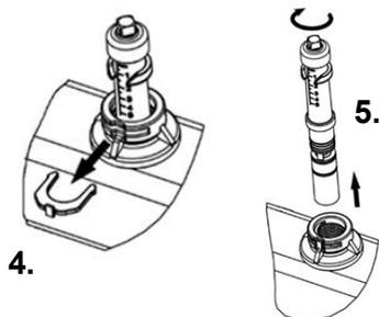
4. Desserrer le clip de sécurité sur le débitmètre à l'aide d'un petit tournevis
