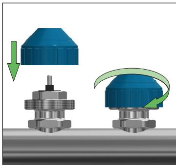
**DE:** Die Ventile im Rücklauf können, z.B. für das Spülen und Befüllen der Heizkreise, geschlossen werden. Dazu die Bauschutzkappe aufsetzen und Ventil rechtsdrehend schließen.
