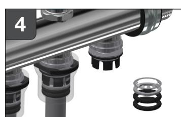
**DE:** Edelstahl-Krallernring (5) mit einer Schneidzange durchschneiden und zusammen mit den O-Ringen (7) und den Abstandshalter (6) vom Rohr entfernen.
