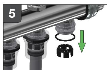
**DE:** O-Ring (3) und Krone (4) vom Messing-Grundkörper (1) entfernen.
