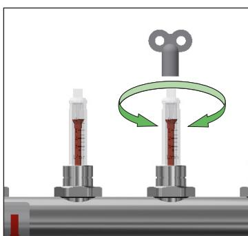
**DE:** Der Durchflussmesser kann mit einem Entlüfter Schlüssel geschlossen werden. Dies ist zum Befüllen und Spülen der Kreise jedoch nicht notwendig.
