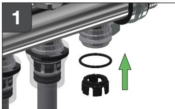
**DE:** Das Ersatzteilset besteht aus Teilen 2-8. Den O-Ring (3) auf den Rand des Grundkörpers (1) aufschieben und Krone (4) auf den Grundkörper (1) aufdrücken.
