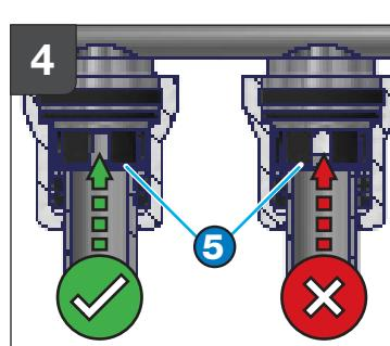
**DE:** Korrekte Position des Rohres Anhand des Schaufensters überprüfen. Das Rohr muss deutlich oberhalb des Krallenrings (5) fixiert sein und das Schaufenster komplett ausfüllen.
