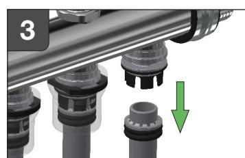
**DE:** Rohr aus dem Steckverbindung Push'n'Go herausziehen.
