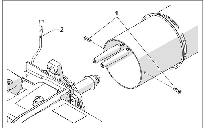
**⚠** Une fois le gueulard démonté, vérifier son bord avant qui doit avoir un profil régulier sans incrustations, brûlures ni déformations.
