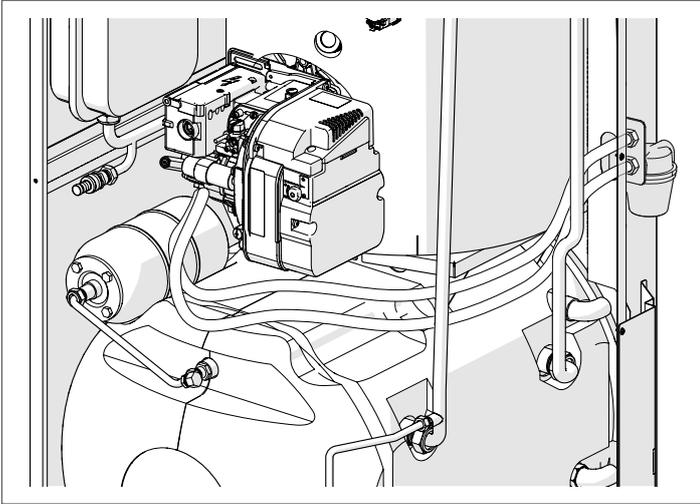
La connexion à l'aspiration de la pompe du fioul doit être effectuée directement sur le filtre (1) (accessoire), le tuyau de retour doit être relié sur le raccord prévu à cet effet (2). Vérifier que les raccordements réalisés sont étanches.
