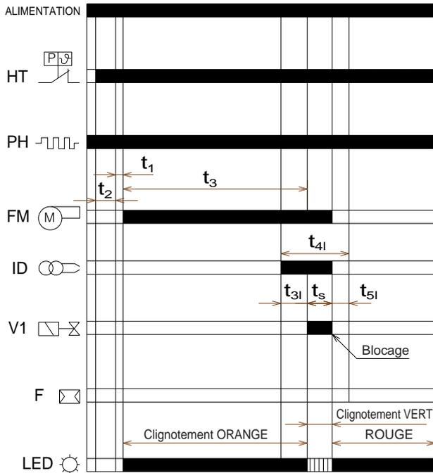
Mise en sécurité causée par la présence d'une lumière étrangère durant la phase de préventilation
