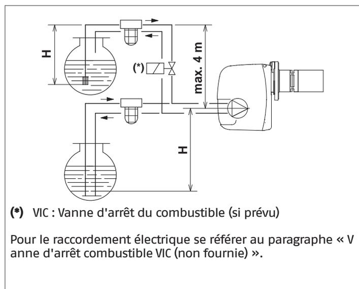
**⚠** Si l'installation d'une vanne d'arrêt du combustible (VIC) est prévue dans le circuit d'alimentation en carburant du fioul du brûleur, la fermeture de la soupape doit être retardée pour éviter que la section de tuyau entre la pompe et la vanne se mette en dépression (vide).
