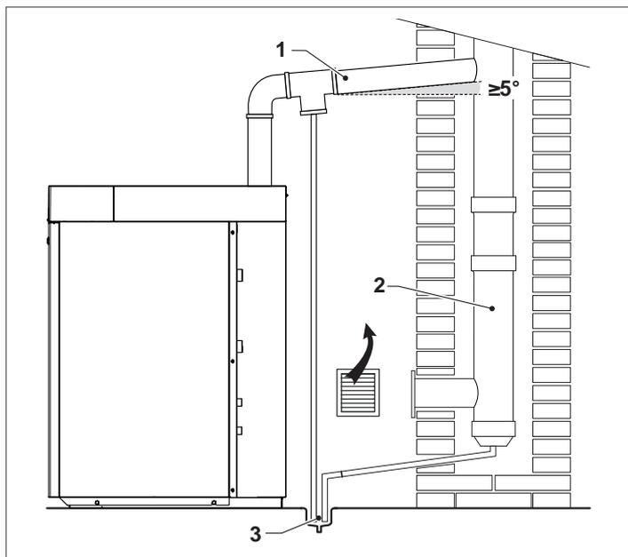
⚠ Le système de vidange des condensats (3) doit être réalisé en conformité avec la législation en vigueur et les éventuelles réglementations locales.
