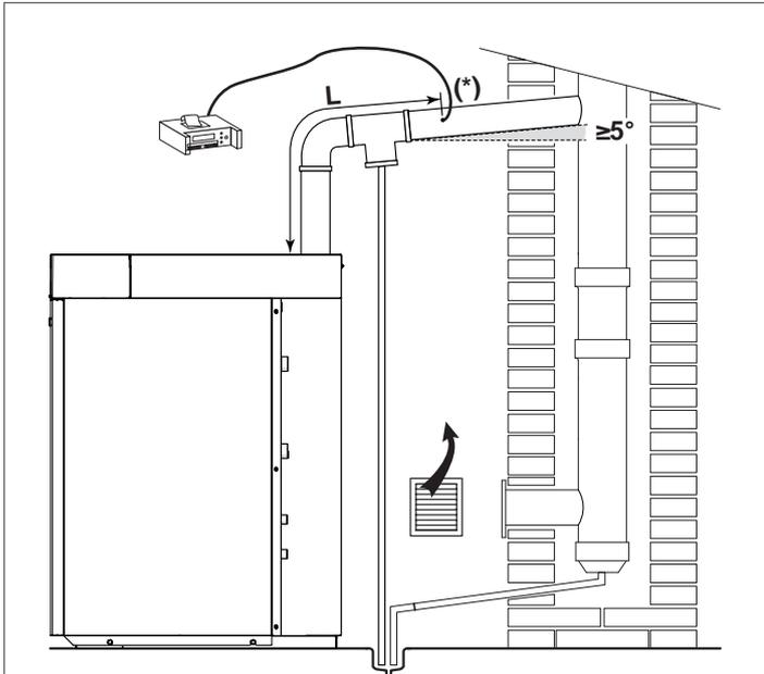
(\* L'ouverture de prélèvement pour l'analyse des fumées doit être réalisée sur la section rectiligne du tuyau de décharge, suffisamment éloignée des courbes et des coudes. Pour les dimensions de l'ouverture et pour connaître sa position correcte L sur le tuyau de décharge (distance minimale ou maximale à respecter de la sortie de l'appareil) se référer aux réglementations en vigueur.
