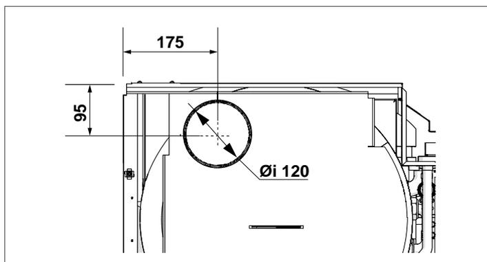
La chaudière **INSIEME EV0e 32 B/110 – B100** aspire l'air comburant de la chaufferie à travers les orifices d'aération qui doivent être réalisés conformément aux normes techniques.
