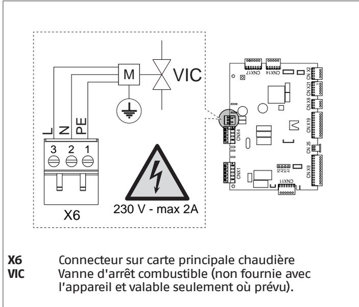
**⚠** Vérifier qu'au paramètre 2030 la valeur 1 (par défaut) soit programmée. Si le temps de post-ventilation du brûleur est modifié, il est nécessaire de programmer au paramètre 2079 une valeur (en secondes)  $\geq$  à celle à peine programmée sur le brûleur.
