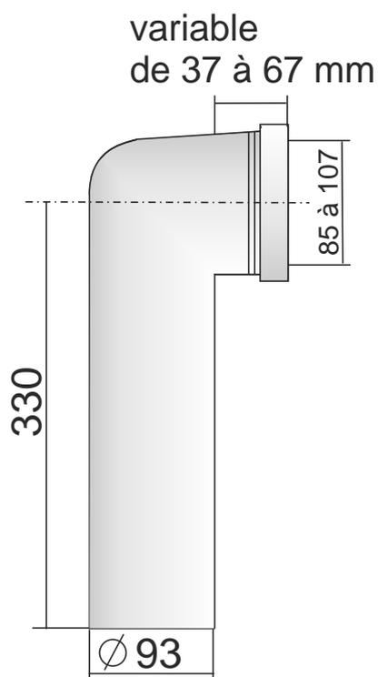
Pipe longue coudée à prise d'air Ø 93 x L 330 mm en PVC
