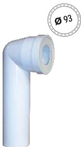
Pipe longue Ø 93 x L 330 mm, femelle-mâle coudée à 90° en PVC, collable, recoupable en profondeur, bague et joint EPDM démontables.
